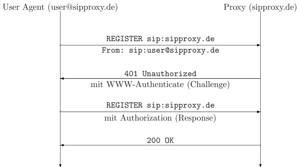
Abbildung 3.2: Ablauf einer Register-Anfrage mit Authentifizierung
